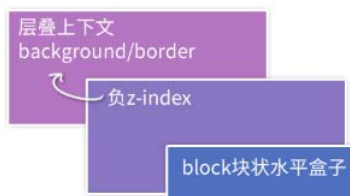
图 7-15 z-index 负值在“层叠上下文”之上
