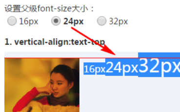
图 5-43 图片上边缘和 24px 文字的内容区域的上边缘对齐
