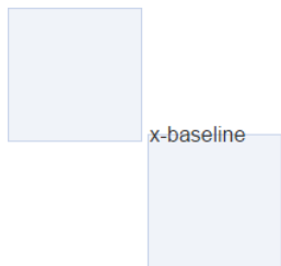
图 5-33 右侧设置 line-height: 0 后的对齐表现
